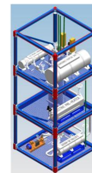
Vertical MEP Module
